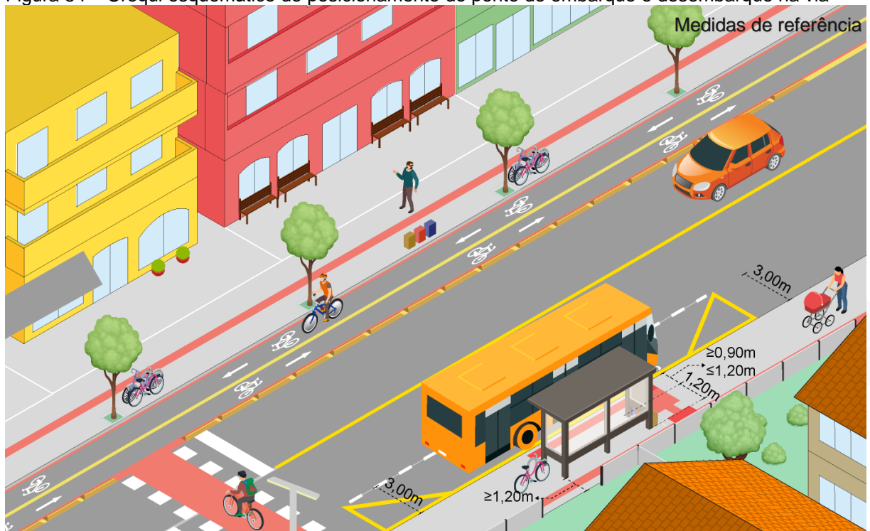
Figura 54 – Croqui esquemático de posicionamento do ponto de embarque e desembarque na via
