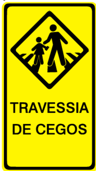
Figura 38 – Placa de advertência de A-33B, complementada com “Travessia de Cegos”
